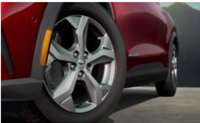
18" KOMPLETNE KOŁA ZIMOWE, ALUMINIOWE Z CZUJNIKAMI CIŚNIANIA OPONY: GOODYEAR UG PERF + SUV XL, 225/60 R18 104V (2 629 405) KOMPLET (4 sztuki) | 9 496 zł
